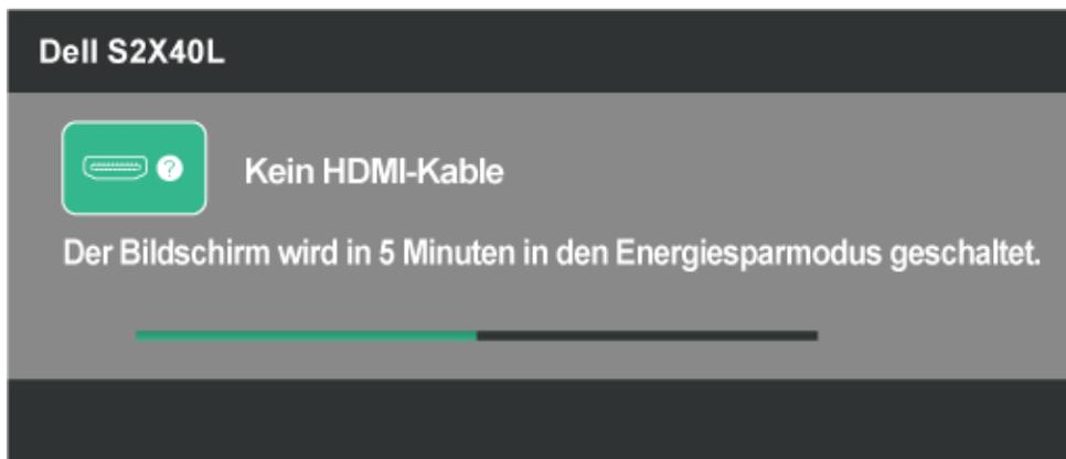
4. Dieses Fenster erscheint auch während des normalen Systembetriebs, falls das Videokabel getrennt wird oder beschädigt ist. Der Monitor ruft **nach 5 Minuten den Energiesparmodus auf**, wenn er in diesem Zustand belassen wird.
