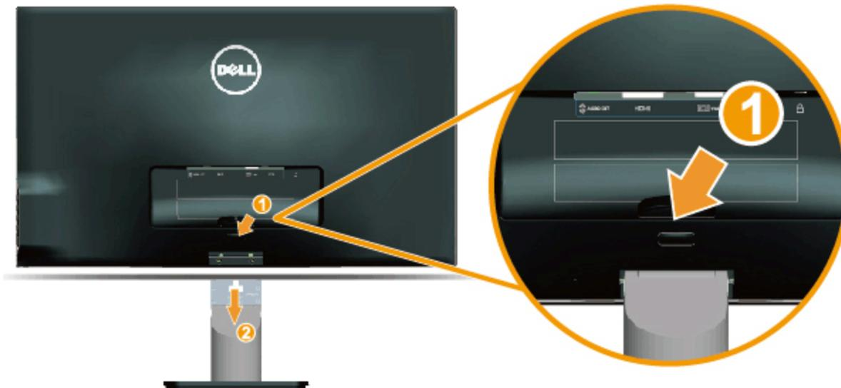
Nachdem Sie den Monitor mit der Bildschirmseite auf ein weiches Tuch oder Polster gelegt haben, schließen Sie die folgenden Schritte zum Entfernen der Basis ab:
