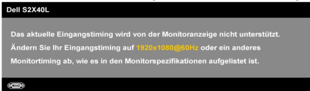
Das bedeutet, dass der Monitor das vom Computer empfangene Signal nicht synchronisieren kann. Den durch diesen Monitor adressierbaren horizontalen und vertikalen Frequenzbereich finden Sie unter [Technische Daten des Monitors](#). Empfohlener Modus: 1920 x 1080.
