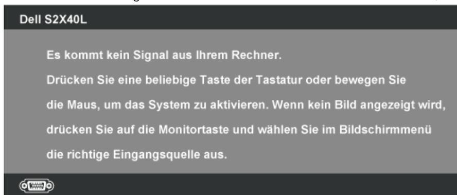
Falls das VGA- oder HDMI-Kabel nicht angeschlossen ist, erscheint wie nachstehend gezeigt ein schwebendes Dialogfenster. Der Monitor ruft **nach 5 Minuten den Energiesparmodus auf**, wenn er in diesem Zustand belassen wird.
